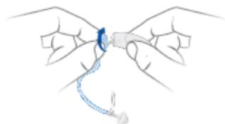
▶ Introduisez avec précaution le fil à nettoyer dans le tube. Commencez du côté opposé à l'adaptateur de l'embout.
