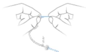
▶ Enfoncez le fil à nettoyer dans le tube jusqu'au bout.
